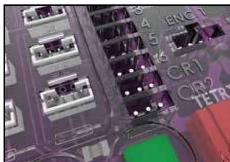
Рисунок 31: Порты для сервоприводов продолжительного вращения (CR) в контроллере PRIZM (Контакты слева направо: 1, 2, 3.) (Маркировка: CR1 и CR2)
