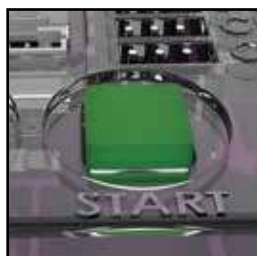
Рисунок 36: Пусковая кнопка на контроллере PRIZM. Включается нажатием.
